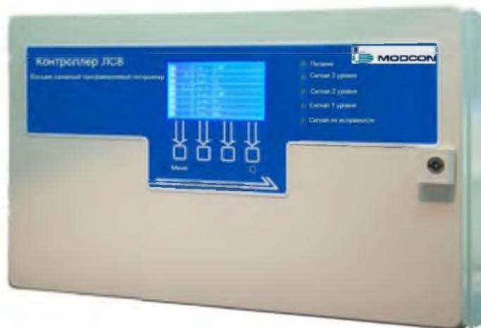
Контроллер LC8 индустриальный контроллер газоанализаторов - 8 каналный контроллер . На передней панели находится графический дисплей (с соответствующей клавиатурой управления), который показывает одновременно текущее значение, тип датчика и его статус (например : сигнализации или неисправность ) для каждого канала, при использовании системы меню можно программировать различные оперативные функций детекторов , такие как уровень сигнала сигнализации , уровень и режимы работы выходов реле.
