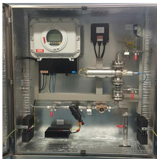
Рисунок 4 - Общий вид анализатора во взрывозащитном исполнении в шкафу, включая: преобразователь, датчик, электрическую систему обогрева и пробоподготовки
